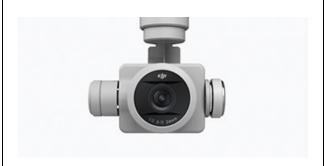
Phantom 4 Pro の内蔵カメラは、 1 インチ 2,000 万画素の CMOS センサーを搭載しています。特別に設計されたレンズは 7 群 8 枚構成で、メカニカルシャッターが採用された DJI 初のカメラです。メカニカルシャッターを使うと、高速飛行中や高速で動く被写体の撮影時に映像が歪んでしまうローリングシャッター現象を回避できます。Phantom 4 Pro のカメラは、実質的に、多くの従来型の地上撮影用カメラと同じようにパワフルなカメラです。よりパワフルな動画処理は H.264 4K 動画を60fps で、または H.265 4K 動画を 30fps で対応しています。ビットレートはともに 100Mbps です。最新のセンサーとプロセッサーにより、映像をより精細に記録し、最新のポストプロダクションで必要なデータを確保します。
