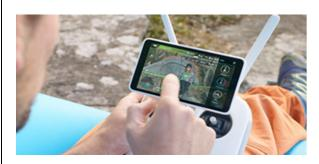
タップするだけで、ディスプレイ上で確認できるどの方向にでも飛行できます。ディスプレイ上の何処かをタップすると、自動で障害物\*を回避しながら、スムーズに飛行方向を調整します。新しい AR ルート機能は、経路を調整しながら参考用に機体の方向をリアルタイムで示します。ジョイスティックを使って高度、コース、速度、カメラピッチを同時にコントロールすることは困難です。TapFly(タップフライ)を使えば、パイロットは飛行方向を設定することができ、飛行方向を変えることなく、必要に応じて Phantom 4 Pro を回転させる、またはジンバルをチルトすることもできます。現在、合計3つの TapFly(タップフライ)モードがあります。
