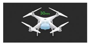
プロフェッショナル向け空撮画像は、より長いフライト時間からメリットを受けます。Phantom 4 Pro の最大フライト時間は約30分です。完璧な撮影を実現するために、より長い時間空中にとどまります。DJI GO アプリはバッテリー残量を表示し、飛行距離などに従ってあとどのくらい飛べるのかを計算します。バッテリー残量が離陸した場所に戻ってこられないレベルに達すると、警告を発します。また、最新のバッテリー・マネジメント・システムで過充電や過放電を防ぎます。長期間にわたって保管される場合には、バッテリーの良好な状態を保つために放電します。
