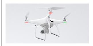
ステレオビジョンセンサーと超音波センサーシステムをさらに強化し、これらのセンサー群が FlightAutonomy (フライトオートノミー)の重要な役割を担います。高解像度になったステレオビジョンセンサーを機体の前方と後方に、赤外線センサーを機体の左右に、ビジョンポジショニングシステム (VPS)を機体下部に設置。これらのセンサー群により、合計で5方向にある障害物を認識でき、GPS がなくても障害物を回避しながら安定した飛行が可能です。
