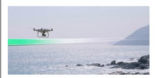
Draw(ドロー)はウェイポイントをコントロールするための最新技術です。ディスプレイ上に線を描くだけで、Phantom 4 Pro は、高度を固定したまま、その描いた線の方向に飛行します。これによりパイロットはカメラ操作に集中することができ、より複雑なショットを撮影することができます。様々な状況で使用できるように Draw(ドロー)には 2 種類のモードがあります。
