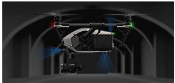
機体の前方と下向きにそれぞれ設置されたビジョン・センサー・システムにより、Inspire 2 は最大 30m 先までの障害物を検知できます。最大傾斜 25°（P モード：前方ビジョンシステム有効時）で、最大 54km/h で飛行しても障害物を回避できます。また、上方の赤外線センサーは、5m 上までの障害物を検知し、狭い空間での安全性がさらに確保されます。障害物検知システムは通常の飛行中、Return-to-Home 中、すべてのインテリジェント・フライトモードにおいて機能します。
