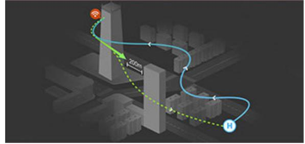
機体の前方と下向きにそれぞれ設置されたビジョン・センサー・システムにより、Inspire 2は、飛行中にリアルタイムで飛行ルートマップを作成します。映像伝送システムの信号がロストして、スマート Return-to-Home が作動すると、元の飛行ルートに沿って帰還します。また、信号が復帰すると、直線の動きに変更します。ホームに帰還する際は、主要なカメラを使って障害物を最大200m先まで認識し、安全な飛行ルートを計画し、そのルートで帰還します。信号を失った場合でも、より迅速に再接続します。
